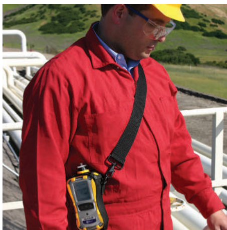
MultiRAE используется для мониторинга вредного воздействия на работников нефтеперерабатывающего завода
