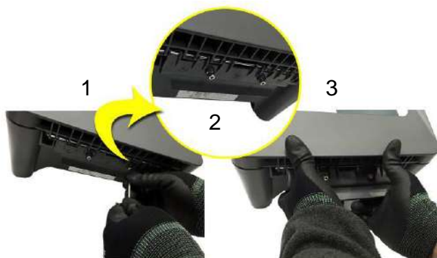
Рисунок 9. Откручивание двух фиксирующих винтов и открытие корпуса
