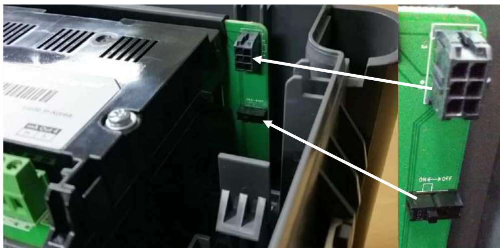
Рисунок 18. Выключатель батареи и разъем батареи
