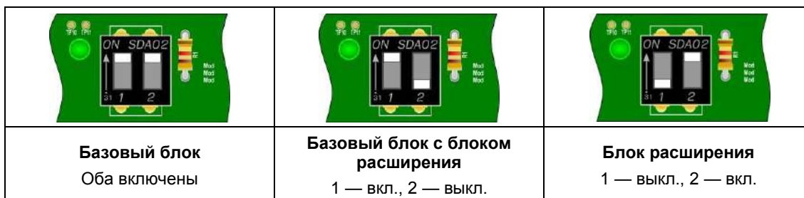
Рисунок 12. Положения микропереключателей на объединительных платах
