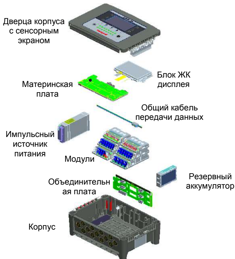
Рисунок 8. Контроллер TPPL в разобранном виде
