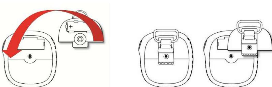
6. Затяните винт. Не перетягивайте винт.
