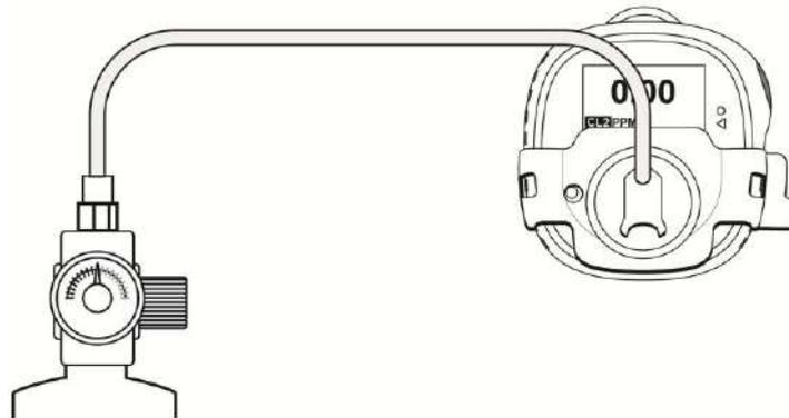
9. Нажмите и удерживайте кнопку для начала проверки работоспособности датчика. Индикатор выполнения показывает, как происходит проверка работоспособности.
