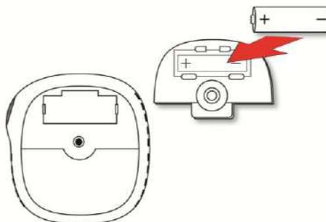
5. Переверните крышку батарейного отсека и поставьте на место. Нажатием вставьте ее в прибор. Установите назад винт и стопорную шайбу.
