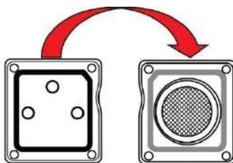
Вставьте датчик в сборе в прибор.
