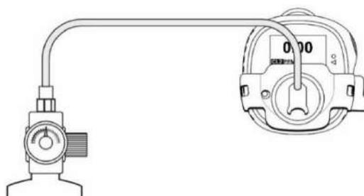
7. Нажмите кнопку и удерживайте ее в течение 1 секунды, чтобы начать калибровку. За процессом калибровки можно следить с помощью индикатора выполнения. После завершения калибровки появится надпись «Passed» (Пройдено) или «Failed» (Не пройдено). Прервать калибровку можно, нажав однократно на кнопку.
