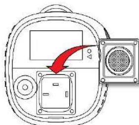
Затяните винты, чтобы закрепить датчик в сборе. Не перетягивайте винты.
