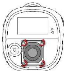
2. Снимите рамку датчика и (если имеется) резиновую прокладку.
