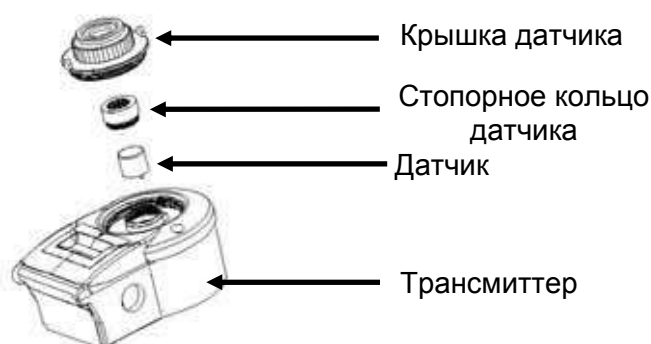
Рис. 7. Замена вставного датчика
